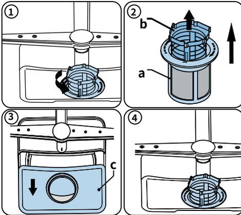
欲取下並清潔濾網組,應逆時針旋轉它,然後往上拉便可取下(1)。將粗濾網從細網器(2)中拉出。接著拉出並取下金屬濾網(3)。用大量的水沖洗濾網,直到完全清除殘餘物。重新安裝濾網。放回濾網,然後順時針旋轉(4)。
