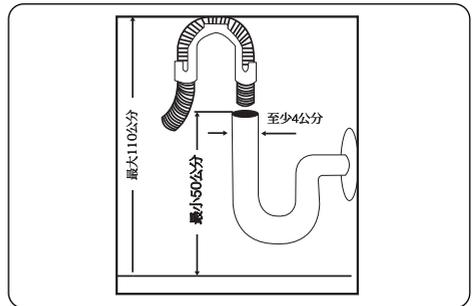
將排水管直接連接到排水孔或水槽的出口栓。這個接線應距離地板至少50公分，最大110公分。
