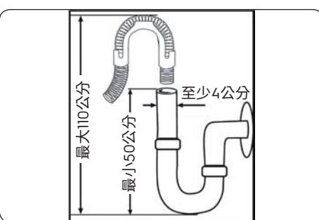
將排水管直接連接到排水孔或水槽的出口栓。這個接線應距離地板至少50公分，最大110公分。
