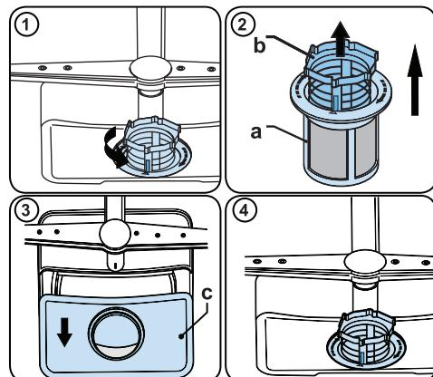
欲取下並清潔濾網組，應逆時針旋轉它，然後往上拉便可取下(1)。將粗濾網從細濾網(2)中拉出。接著拉出並取下金屬濾網(3)。用大量的水沖洗濾網，直到完全清除殘餘物。重新安裝濾網。放回濾網，然後順時針旋轉(4)。
