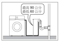
排水軟管出水端必須保持暢通,即排水管道的內徑必須大於排水軟管的外徑。
