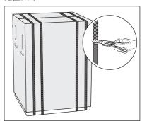
取下紙箱盒。取出所有聚苯乙烯泡 沫包裝材料。撕掉洗衣機外覆的塑 膠包裝袋。
