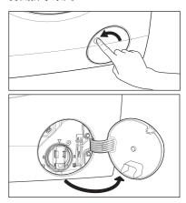
在排水泵凹槽下方放置一個容器, 以收集流出的水。
