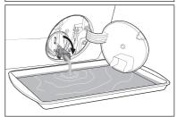
3. 容器水滿後,將疏水管放回原位, 然後倒掉容器中的水。 重複第 2、3 5. 清除泵中的絮狀物和髒物(如果有的話)。 步,直到排水泵不再流水為止。
