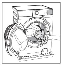
4. 將其中一塊聚苯乙烯泡沫包裝,放在 洗衣機後面的地面上。小心地將洗 衣機背面朝下,平放在地面上。確保 不要損壞水管。
