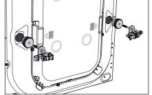
全使用洗衣機前,必須拆除 所有搬運部分(3個組成部分)。
