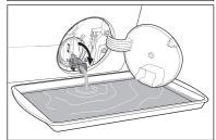
3. 容器水滿後,將疏水管放回原位 然後倒掉容器中的水。 重複第2、3 步,直到排水泵不再流水為止。
