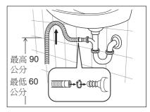
將排水管推到水龍頭,並用夾子固定, 確保在排水管中形成一個迴路,防止水 槽中的廢棄物進入裝置。
