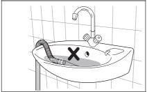
採用這種方式時,請確保出水端不會在洗 衣機排水過程中脫落。要做到這一點,可 將排水軟管繫在水龍頭上或固定在牆上。
